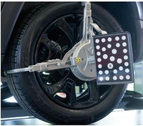
La abrazadera se acopla al neumático con una fuerza de sujeción limitada sin tocar la llanta para una colocación segura, rápida y coherente en todo momento.
