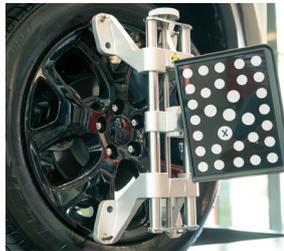
Rápidas y fáciles de usar con un diseño autocentrante, las garras de dos lados proporcionan una sujeción fiable, incluso sobre los tapacubos.
