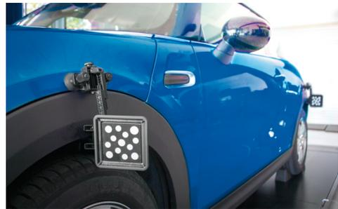
Diga adiós a la introducción manual de datos, acelere las mediciones y aumente la precisión utilizando nuestros objetivos de altura de conducción opcionales y especialmente diseñados.
